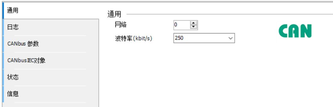
图 15-1 CAN端口参数配置界面
